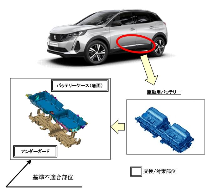
駆動用バッテリーにおいて、バッテリーケース底面の防錆処理が不十分な為、長期間使用した場合、当該ケースに錆が発生して穴があくことがある。このため、バッテリーケース内に水が侵入して短絡が発生し、最悪の場合、車両の走行停止や火災に至るおそれがある。
