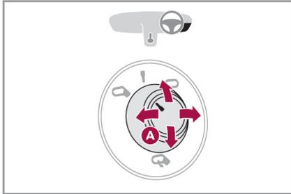
調整するミラーに合わせて、スイッチ **A** を左側または右側に回します。ミラーはスイッチ **A** を動かして上下左右に角度が変えられます。調整が終わったら、スイッチ **A** を中央の位置に戻します。
