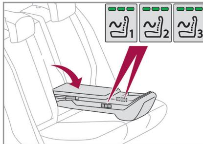
**ENGINE START/STOP** スイッチがアクセサリポジションの状態のとき、またはハイブリッドシステムが始動している状態のときに使用できます。リアアームレストを手前に引き下ろし、側面にある3つのボタンのいずれかを押して設定したサポートの種類とサポート量に自動調整されます。
