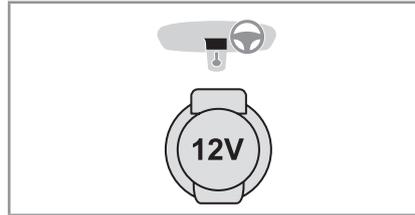
12V 電源（最大使用電力：120 W）を使用する際は、カバーを持ち上げてはし、適切なアダプターを接続します。
