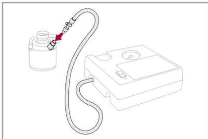
4. 修理剤カートリッジをコンプレッサーに固定します。仕様により、コンプレッサーのカバーを開け、表示に合わせて修理剤カートリッジを時計回りに回して固定します。
