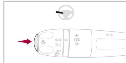
ライトスイッチレバー先端のスイッチを押すとディスプレイゾーンのページが切り替わります。
