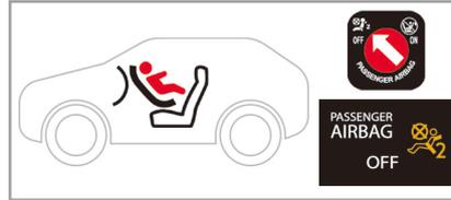
後ろ向きチャイルドシートを助手席に取り付ける際、助手席エアバッグの機能をキャンセルすることが必要です。
