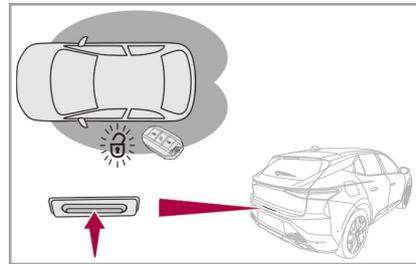
車両周辺の検知エリアにスマートキーがあるときに、テールゲートのスイッチを押します。すべてのドアおよびテールゲートが解錠され（すべてのドアのドアハンドルが展開します）、テールゲートが少し開きます。
