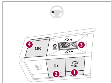
アクティブクルーズコントロールは、ステアリングスイッチのボタンを使用して設定します。
