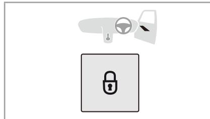
運転席ドアにある集中ロックボタンを押すと、車両が施錠されます。施錠すると集中ロックボタンのインジケータが点灯／点滅します。
