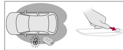
スマートキーを携帯してゾーンBに入ります。または、車両周辺の検知エリアにスマートキーがあるときに、いずれかのドアのドアハンドルを軽く押します。すべてのドアおよびテールゲートが解錠され、すべてのドアのドアハンドルが展開します。
