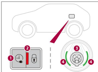
リチウムイオンバッテリーを充電するときは、車載充電ケーブルの充電コネクタ、または充電器に付属の充電ケーブルの充電コネクタを車両の普通充電ポートに接続します。
