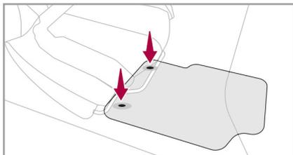
取り付けるときは、フロアマットを正しい位置に合わせ、クリップで留めてください。フロアマットがしっかり固定されていることを確認してください。
