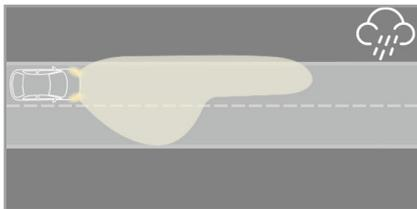
ヘッドランプモジュールの配光を強めて横方向の照射範囲を広げ、走行車線の車線マーカの視認性を高めます。また、ハイビームの照射範囲を制御して濡れた路面からの反射光を抑えて照射します。照射距離は約220mです。
