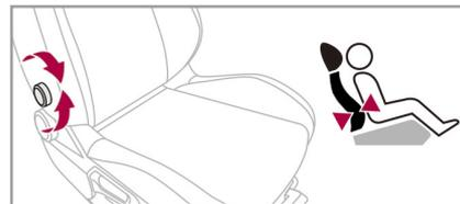
ダイヤルを回してランバーサポートを調整します。
