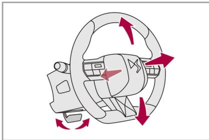
ロックレバーを手前に引くと、ステアリングのロックが解除されます。ステアリングホイールの高さや奥行きを調整し、ロックレバーを押し下げてロックしてください。ステアリングがしっかり固定されていることを確かめてください。
