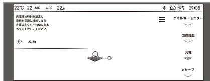
通常は普通充電ポートに充電コネクタを差し込むとすぐにリチウムイオンバッテリーの充電を開始しますが、充電の開始時刻をあらかじめ設定しておくことで、お好みの時間帯にリチウムイオンバッテリーの充電を開始することができます。
