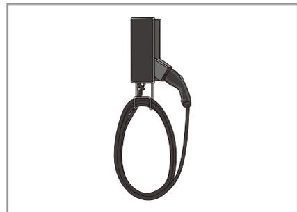
6kW普通充電（AC200V 30A）は、壁掛け型やスタンド型などのEV車専用の6kW普通充電器と充電器に付属の充電ケーブルで行う充電方法です。3kW普通充電の約2倍のスピードで充電することができます。充電が完了するまでの時間の目安は、約2時間半です。
