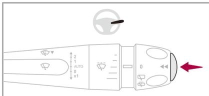
ドライブコンピューターは、ワイパーレバー先端のスイッチを押すことにより、**ゼロ・エミッション**、**トリップ1**、**トリップ2**を切り替えて表示します。
