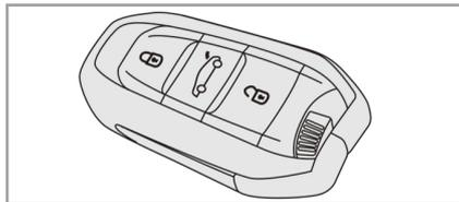
DS 4 E-TENSEには、スマートキーを携帯しているだけで、ドアやテールゲートの解錠／施錠やハイブリッドシステムの始動ができる、プロキシミティキーレスエントリー機能が装備されています。プロキシミティキーレスエントリー機能は、スマートキーを携帯して車両の検知エリアに入る／出るとドアやテールゲートの解錠／施錠が自動的に行われます。また、スマートキーをリモコンとして使い、ボタンの操作で施錠／解錠することもできます。スマートキーには緊急用キーが付いています。
