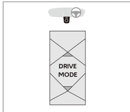
走行状況に応じて、センターコンソールにあるボタンを押してドライブモード (ELECTRIC、HYBRID、SPORT、COMFORT) を選択することができます。
