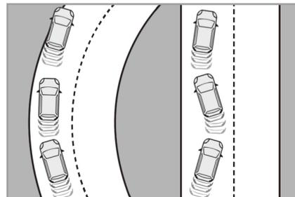
疲労検知システムは、フロントウィンドウ上部のカメラで走行車線の車線マーカを検知し、車両のふらつきから運転者の疲労増加や注意力の低下を判断し、警告音とともにメッセージを表示して運転者に休憩をとるように促します。高速道路や自動車専用道路など、時速70km以上で走行しているときの使用が効果的です。
