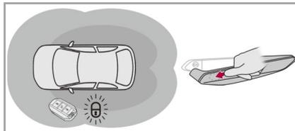
スマートキーを携帯し、車両から離れてゾーンAから出ます。ブザーが鳴り、すべてのドアおよびテールゲートが施錠され、すべてのドアのドアハンドルが格納します。または、車両周辺の検知エリアにスマートキーがあるときに、いずれかのドアのドアハンドルを軽く押します。すべてのドアおよびテールゲートが施錠され、すべてのドアのドアハンドルが格納します。
