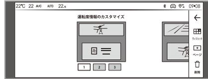
インストルメントパネルのディスプレイゾーンのカスタマイズは、ディスプレイゾーンの各ページにウィジェットを追加または削除して行います。カスタマイズを行うには、まず次のように操作してください。
