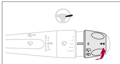
リングを回すとリアワイパーが作動します（間欠式）。リングをいっぱいまで回している間、ウォッシャー液が噴射され、ワイパーが作動します。リングを放すと数秒後にワイパーが停止します。
