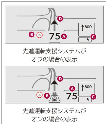
DSエクステンデッドヘッドアップディスプレイは、運転者が前方を見ながら運転に必要な情報を確認できるように、フロントウィンドウに先進運転支援システムの作動状況や走行に関する様々な情報を表示します
