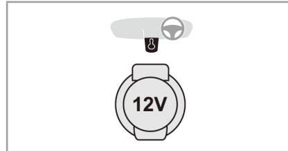
12V電源（最大使用電力：120W）を使用する際は、カバーを持ち上げてはずし、適切なアダプターを接続します。
