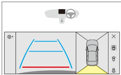
フロントグリルのカメラ、ドアミラー下部のカメラ、リアバンパーに取り付けられたカメラ、およびフロント/リアバンパーに埋め込まれたセンサーが、タッチスクリーンに車両前方/後方/側方および前方/後方周囲の映像を映し出し、駐車や出庫の際の安全確認を補助します。タッチスクリーンの画面は4分割され、左側/右側にメニュー、中央左側にフロント/サイド/バックビュー、中央右側に車両上方からの映像が表示されます。
