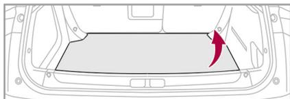
パンク修理キットと工具は、ラゲッジルームマットの下にある専用バッグの中に格納されています。ラゲッジルームマットを持ち上げると専用バッグにアクセスできます。
