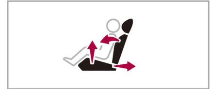
バックレストを元の位置に戻し、シートを一番後ろまで下げてください。高さ調整機能が装備されている場合は、シートの高さを一番高い位置に調整してください。
