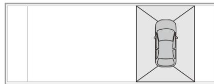
車両上方からの映像は、フロントグリルのカメラ、ドアミラー下部のカメラ、およびリアバンパーに取り付けられたカメラの映像を合成して表示します。駐車や出庫の際に、車両周囲の障害物を確認できます。フロント/バックビューに連動して作動します。また、車両上方からの映像の前後左右にある各セクションをタップすると、タッチスクリーン画面中央左側に表示されるフロント/サイド/バックビューの表示を切り替えることができます。
