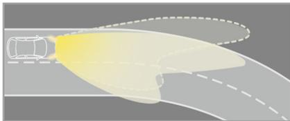
ステアリングが一定の角度以上回っているとき、ヘッドライトがカーブの内側を照らします。ステアリングが一定の角度まで回っていないときや、シフトポジションがRのときは作動しません。
