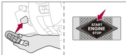
4. ブレーキペダルを踏みながら**ENGINE START/STOP**スイッチを押します。
