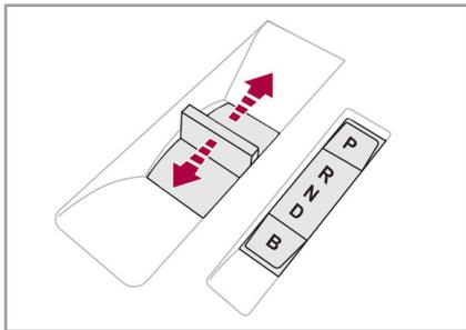
プッシュセレクターを前後に動かす、またはプッシュセレクターの右側にあるスイッチを押してシフトポジションを選択します。選択されているシフトポジションは、インストルメントパネルおよびプッシュセレクターの右側にあるインジケーターに表示されます。**ENGINE START/STOP**スイッチをオフにしてもしばらくの間、インジケーターにシフトポジションが表示されます。
