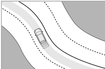
レーンポジショニングアシストは、アクティブクルーズコントロール（ストップ&ゴー機能付き）と連動して機能するシステム（DSコネクテッドパイロット）です。
