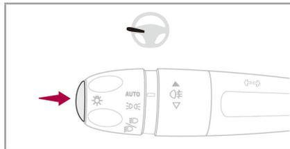
ライトスイッチレバー先端のスイッチを押すとディスプレイゾーンのページが切り替わります。
