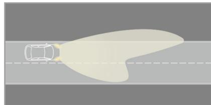
ヘッドランプの前方への照射範囲を広げて照射し、横方向への照射範囲は十分に保ったまま、ヘッドランプモジュールの配光を減光します。照射距離は約240mです。
