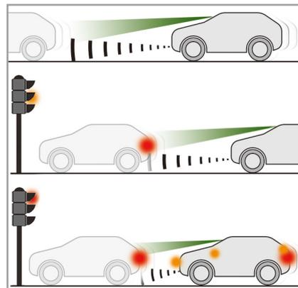
ディスタンスアラートの警告が表示されたあとも運転者が衝突回避動作を取らなかったとき、自動ブレーキが作動し、衝突回避を支援したり、衝突時の速度を低減します。
