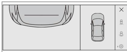
障害物がリアバンパーの後方約30cm（バックビューの赤いライン）に近付くと車両を上から見たような映像がタッチスクリーンに表示されます。
