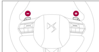
ステアリングの裏側にパドルスイッチがあります。シフトポジションがDでガソリンエンジンが始動している状態のとき、右側(+)のスイッチでシフトアップ、左側(-)のスイッチでシフトダウンします。
