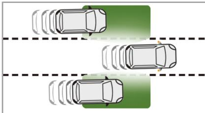
ブラインドスポットモニターロングレンジは、リアバンパーに埋め込まれたレーダーが、隣接する車線を後方から急速に接近してくる車両や（最大75m後方までモニターします）、ドアミラーでの確認が困難な範囲に車両が進入した際に、その存在を検知して運転者に警告するシステムです。
