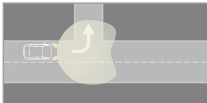
ヘッドランプの前方への照射範囲を適度に保ったまま、ヘッドランプモジュールを外側方向へ向け、照射範囲を横方向に拡大して照射します。夜間の交差点などでの視認性を高めます。照射距離は約230mです。
