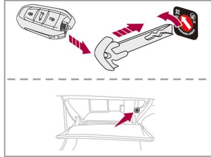
チャイルドシートを進行方向とは逆向きに助手席へ取り付けるときは、助手席のエアバッグが作動しないようにします。これはエアバッグが作動してふくらんだときの衝撃からお子さまを守るためです。
