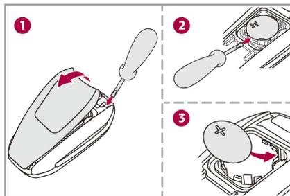
リモコンの電池が消耗すると、メッセージが表示されます。切れ込みに細いドライバーなどを差し込んでケースを開け①、電池を交換してください②③。
