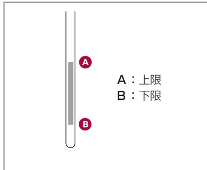
レベルゲージに付着したオイルの汚れ具合も点検します。オイルはエンジンの回転によって消費されますので、次のオイル交換までの間にオイルを補充しなければいけないことがあります。走行5000kmごとにオイルレベルを点検し、必要に応じて補充してください。オイルの消費量が急に増えたり、汚れがひどくなったときは、当社指定サービス工場で点検を受けてください。
