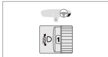
ラゲッジルームに重量物を積んでヘッドランプが上向きになったときは、対向車に眩しくないよう、ダイヤルの数値を上げて照射角度を下向きにしてください。
