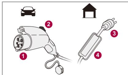
車両に付属の充電ケーブル（コントロールユニット付き）は、EV車専用のコンセントで3kW普通充電するときを使用します。
