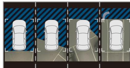
車両上方からの映像は、リアバンパーに取り付けられたカメラの映像を合成して表示します。駐車や出庫の際に、車両後方周囲の障害物を確認できます。
