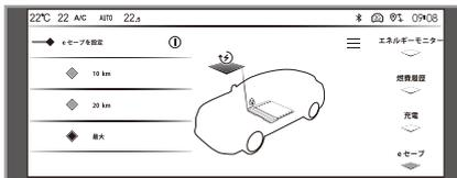
EV走行するためのリチウムイオンバッテリー残量を温存する機能です。例えば、夜間の住宅地など、静かな走行が必要な場面があり、どうしてもEV走行するためのリチウムイオンバッテリーの電力を温存しておきたい場合に使用します。
