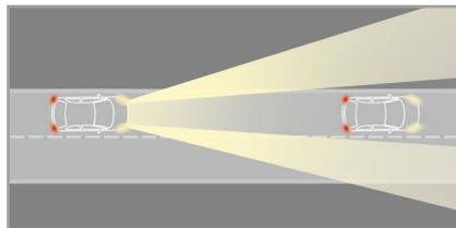
先行車を検知すると、先行車の周囲を照らすLEDランプユニットのみ消灯します。
