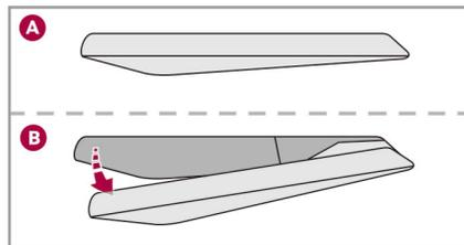
リトラクタブルドアハンドルは車両の施錠/解錠に合わせて自動的に格納A/展開Bします。
