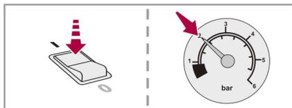
9. スイッチを**0**にしてから、パンク修理キットを取りはずし、直ちに走行してタイヤ内に修理剤を行き渡らせます。このとき、時速**20～60km**で約**5km**走行します。
