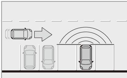
リアクロストラフィックアラートは、リアバンパーに埋め込まれたレーダーを使用して、車両後側方の目視での確認が困難な範囲に接近してくる車両、オートバイ、自転車、歩行者の存在を検知して運転者に警告するシステムです。最大40mまで離れた位置から、時速3km～時速10kmで接近してくる車両などを検知します。
