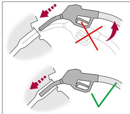
5. 給油ノズルのオートストップが3回働いたら、それ以上給油口にあふれるまで給油しないでください。
