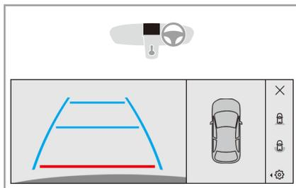
リアバンパーに取り付けられたカメラ、およびリアバンパーに埋め込まれたセンサーがタッチスクリーンに車両後方および後方周囲の映像を映し出し、駐車や出庫の際の安全確認を補助します。
