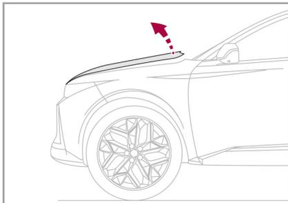
万一、歩行者と衝突したとき、車両前方への衝撃を感知すると、ボンネットの後部を瞬時に持ち上げ、エンジンルーム内の部品との空間を広く確保することで、歩行者の頭部への衝撃を軽減します。
