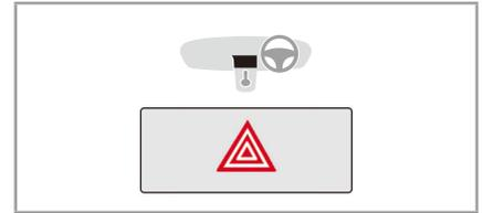
ENGINE START/STOPスイッチのポジションに関係なくスイッチを押すと作動します。
