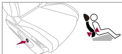
スイッチの前後を押してランバーサポートの張り出しを調整します。
