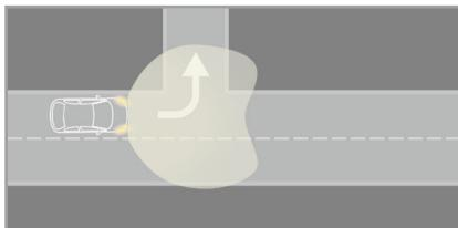
ヘッドライトの前方への照射範囲を適度に保ったまま、ヘッドライトモジュールを外側方向へ向け、照射範囲を横方向に拡大して照射します。夜間の交差点などでの視認性を高めます。照射距離は約230mです。
