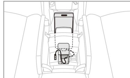
センターコンソールのスマートフォンホルダーにスマートフォンを設置し、フロントアームレスト前面からUSBケーブルを通すとUSB接続したスマートフォンをすっきりと格納することができます。
