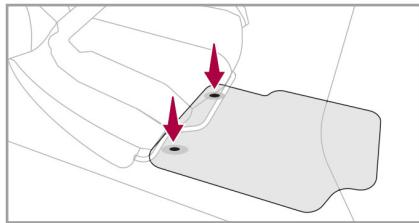
取り付けるときは、フロアマットを正しい位置に合わせ、クリップで留めてください。フロアマットがしっかりと固定されていることを確認してください。
