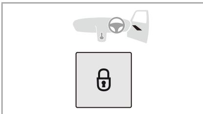
運転席ドアにある集中ロックボタンを押すと、車両が施錠されます。施錠すると集中ロックボタンのインジケーターが点灯／点滅します。
