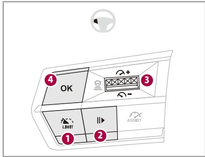
スピードリミッターは、ステアリングスイッチのボタンを使用して設定します。
