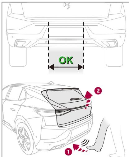
ハンズフリー機能は、車両後方の検知エリアにスマートキーがあるときに、リアバンパーの下部で、イラストのOKの範囲にある検知エリアに足を蹴り出すことで①、テールゲートの開閉、または停止を行うことができます②。
