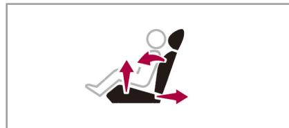
バックレストを元の位置に戻し、シートを一番後ろまで下げてください。高さ調整機能が装備されている場合は、シートの高さを一番高い位置に調整してください。
