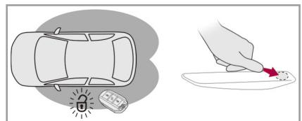
スマートキーを携帯してゾーンBに入れます。または、車両周辺の検知エリアにスマートキーがあるときに、いずれかのドアのドアハンドルを軽く押します。すべてのドアおよびテールゲートが解錠され、すべてのドアのドアハンドルが展開します。
