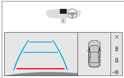
リアバンパーに取り付けられたカメラ、およびリアバンパーに埋め込まれたセンサーがタッチスクリーンに車両後方および後方周囲の映像を映し出し、駐車や出庫の際の安全確認を補助します。タッチスクリーンの画面は3分割され、左側にバックビュー、中央に車両上方からの映像、右側にメニューが表示されます。
