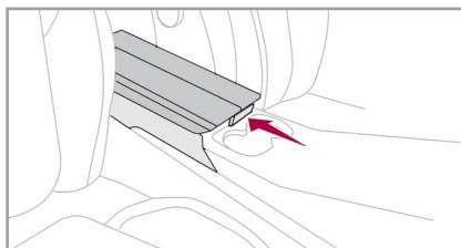
アームレストのボタンを押すとカバーが開きます。ENGINE START/STOPスイッチがアクセサリーポジションのとき、またはエンジンが始動している状態のときに開けると中の照明が点灯します。\*
