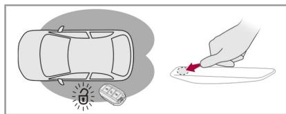
スマートキーを携帯してゾーンBに入れます。または、車両周辺の検知エリアにスマートキーがあるときに、ドアハンドルを軽く押します。すべてのドアおよびテールゲートが解錠され、すべてのドアのドアハンドルが展開します。
