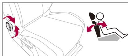
ダイヤルを回して背もたれの角度を調整します。
