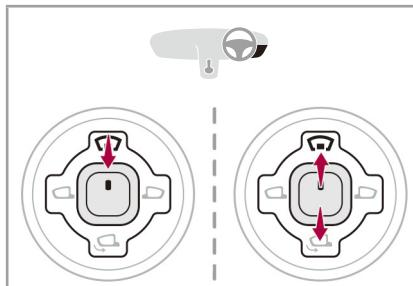
**ENGINE START/STOP**スイッチがアクセサリーポジションのとき、またはエンジンが始動している状態のときに、運転席側ダッシュボードのレバーを上側（中央の位置）に回してから、上下に動かして、ディスプレイが見やすい高さになるように調整します。
