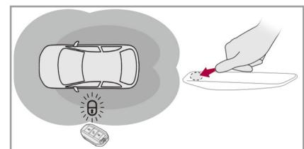
スマートキーを携帯し、車両から離れてゾーンAから出ます。ブザーが鳴り、すべてのドアおよびテールゲートが施錠され、すべてのドアのドアハンドルが格納します。または、車両周辺の検知エリアにスマートキーがあるときに、ドアハンドルを軽く押します。すべてのドアおよびテールゲートが施錠され、すべてのドアのドアハンドルが格納します。
