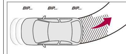
●ソナーの警告音は、タッチスクリーンの操作で音量を調整できます。
