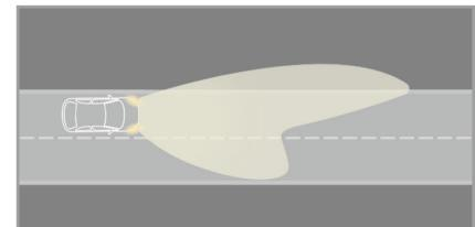
ヘッドライトの前方への照射範囲を広げて照射し、横方向への照射範囲は十分に保ったまま、ヘッドライトモジュールの配光を減光します。照射距離は約240mです。
