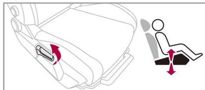
レバーを上下に動かして高さを調整します。
