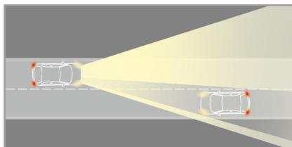
対向車を検知すると、対向車の周囲を照らすLEDランプユニットのみ消灯します。
