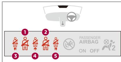
インストルメントパネルの警告灯とシートベルト着用／非着用ディスプレイの警告灯①から⑤が点灯または点滅して、シートベルトの着用状況を表示します。
