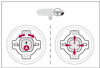
調整するミラーに合わせて、スイッチAを左側または右側に回します。
