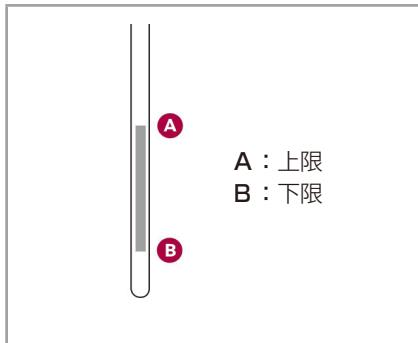
レベルゲージに付着したオイルの汚れ具合も点検します。オイルはエンジンの回転によって消費されますので、次のオイル交換までの間にオイルを補充しなければいけないことがあります。
