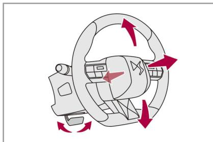
ロックレバーを手前に引くと、ステアリングのロックが解除されます。
