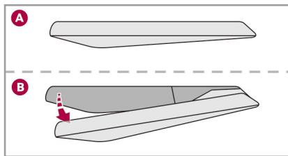
リトラクタブルドアハンドルは車両の施錠／解錠に合わせて自動的に格納A／展開Bします。
