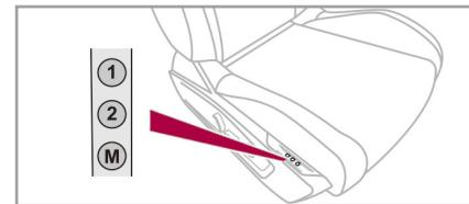
お好みのシートポジション（運転席の位置、ドアミラーの角度）および DS エクステンデッドヘッドアップディスプレイ\* の高さ調整を登録し、ワンタッチで呼び出することができます。シートポジションは運転席シートにあるボタンに2人分まで登録できます。
