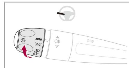
周囲が暗くなったりウインドウワイパーが作動すると、自動的にポジションランプやヘッドライトが点灯します。周囲が明るくなったりワイパーが停止すると、自動的に消灯します。
