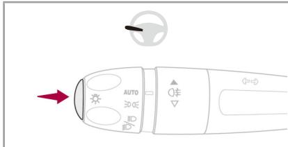
ライトスイッチレバー先端のスイッチを押すとDSエクステンデッドヘッドアップディスプレイに表示されたメッセージを閉じることができます。
