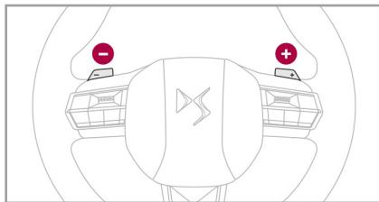
ステアリングの裏側にパドルスイッチがあります。シフトポジションが**D**または**M**のとき、右側（+）のスイッチでシフトアップ、左側（-）のスイッチでシフトダウンします。
