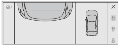
障害物がフロントバンパーの前方またはリアバンパーの後方約30cm（フロント／バックビューの赤いライン）に近付くと車両前方または後方を上から見たような映像に切り替わります。
