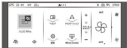
タッチスクリーンのボタン を押すとホームページが表示されます。ホームページは最大6つ（DSエクステンデッドヘッドアップディスプレイ非装備車は5つ）のページを切り替えて表示することができ、それぞれのページにおいて、次の11種類のカテゴリの中からアプリケーションまたは情報（ウィジェット）をお好みにより選択して表示させることができます。
