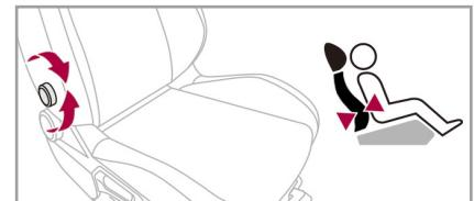
ダイヤルを回してランバーサポートを調整します。
