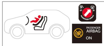
前向きチャイルドシートを取り付ける際、助手席エアバッグの機能はキャンセルしないでください。
