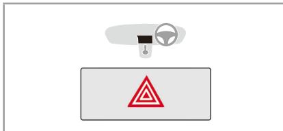
ENGINE START/STOPスイッチのポジションに関係なくスイッチを押すと作動します。
