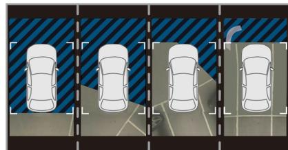
車両上方からの映像は、リアバンパーに取り付けられたカメラの映像を合成して表示します。駐車や出庫の際に、車両後方周囲の障害物を確認できます。バックビューに連動して作動します。
