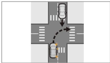
アクティブセーフティブレーキは、交差点で右折して対向車の進路を横切るとき、衝突の可能性が高いとシステムが判断した場合にも作動します。
