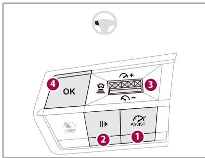
アクティブクルーズコントロールは、ステアリングスイッチのボタンを使用して設定します。
