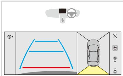
フロントグリルのカメラ、ドアミラー下部のカメラ、リアバンパーに取り付けられたカメラ、およびフロント／リアバンパーに埋め込まれたセンサーが、タッチスクリーンに車両前方／後方／側方および前方／後方周囲の映像を映し出し、駐車や出庫の際の安全確認を補助します。タッチスクリーンの画面は4分割され、左側／右側にメニュー、中央左側にフロント／サイド／バックビュー、中央右側に車両上方からの映像が表示されます。
