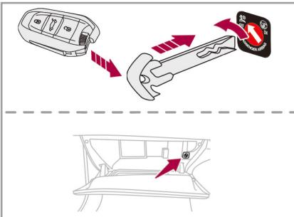
チャイルドシートを進行方向とは逆向きに助手席へ取り付けるときは、助手席のエアバッグが作動しないようにします。これはエアバッグが作動してふくらんだときの衝撃からお子さまを守るためにです。
