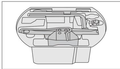
ジャッキと工具は、ラゲッジフロアボードの下にある工具入れに格納されています。
