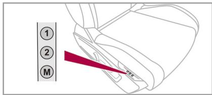
お好みのシートポジション（運転席の位置、ドアミラーの角度）およびDSエクステンデッドヘッドアップディスプレイ\*の高さ調整を登録し、ワンタッチで呼び出すことができます。
