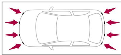
フロント／リアバンパーに埋め込まれたセンサーが障害物（歩行者、車、立木、門など）を検知します。
