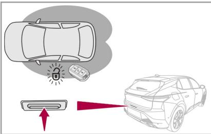
車両周辺の検知エリアにスマートキーがあるとき、テールゲートのスイッチを押します。すべてのドアおよびテールゲートが解錠され（すべてのドアのドアハンドルが展開します）、テールゲートが少し開きます。
