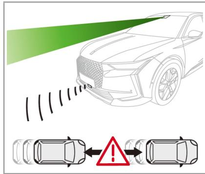
アクティブセーフティブレーキは、フロントウィンドウ上部のカメラとフロントバンパーのレーダーにより前方の車両や停車中の車両、歩行者、自転車を検知し、衝突の危険性が高まったとき、警告を表示して運転者に注意を促します。また、運転者が衝突回避動作を取らなかったときは、自動ブレーキを作動させることで車両の速度を落とし、衝突の回避支援、または衝突時の速度を低減するシステムです。
