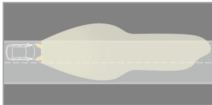
高速走行時にハイビームを点灯してより遠方の視認性を向上します。照射距離は約280mです。
