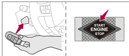
4. ブレーキペダルを踏みながら**ENGINE START/STOP**スイッチを押します。
