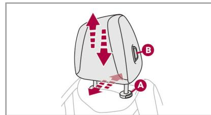
調整は、ヘッドラストの上端と前席乗員の頭の上が揃うようにします。
