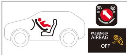
後ろ向きチャイルドシートを取り付ける際、助手席エアバッグの機能をキャンセルすることが必要です。
