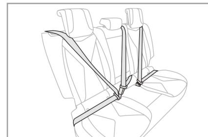
リアシートベルトは3点式です。両サイドのシートのシートベルトはフォースリミッター付きシートベルトプリテンションシステムです。
