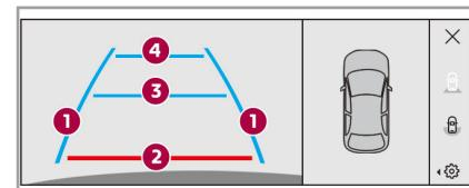
車両後方の映像がタッチスクリーンに表示されます。
