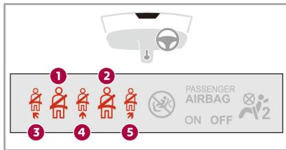
インストルメントパネルとシートベルト着用／非着用ディスプレイの警告灯が点灯または点滅して、シートベルトの着用状況を表示します。
