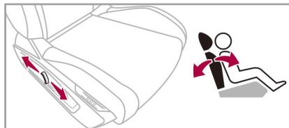
スイッチを前後に倒して背もたれの角度を調整します。
