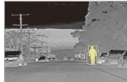
システムが歩行者や動物を検知すると、黄色の注意喚起枠とともにインストルメントパネルのディスプレイゾーンに表示されます。
