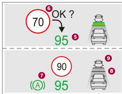
アクティブクルーズコントロールの情報は、インストルメントパネルのディスプレイにミニビューとして表示されます。
