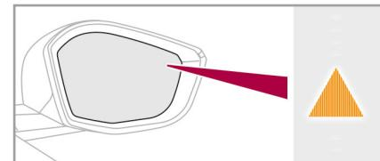
ドアミラーの確認が困難な範囲に車両を検知した直後、または隣接する車線を後方から接近してくる車両を検知した直後に、検知した側のドアミラーの警告灯が点灯します。検知した側の方向指示器を作動させた場合は、約1秒後にドアミラーの警告灯が点滅します。
