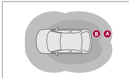
スマートキーを携帯して車両の検知エリアに入る／出ると車の解錠／施錠が自動的に行われます。
