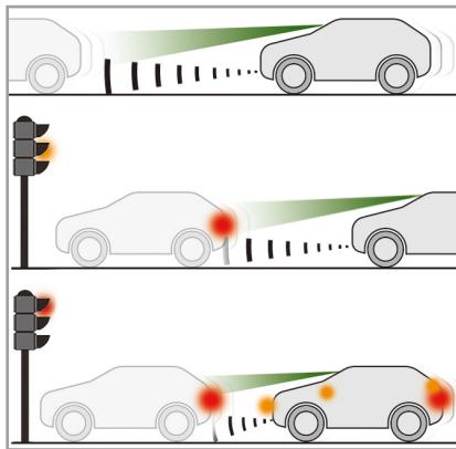
ディスタンスアラートの警告が表示されたあとも運転者が衝突回避動作を取りなかつたとき、自動ブレーキが作動し、衝突回避を支援したり、衝突時の速度を低減します。
