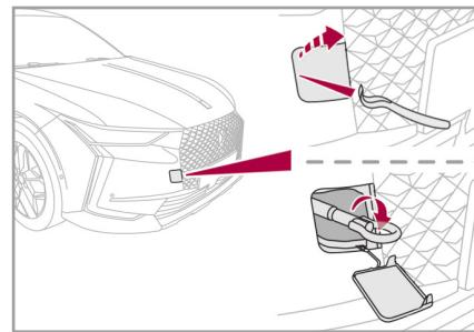
1. カバーのすき間に、カバーオープナー\*またはボディーを傷つけないプラスチック製の先の平らな工具などを差し込み、手前に引いてはずします。
