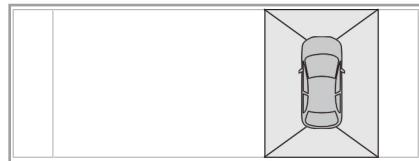
車両上方からの映像は、フロントグリルのカメラ、ドアミラー下部のカメラ、およびリアバンパーに取り付けられたカメラの映像を合成して表示します。駐車や出庫の際に、車両周囲の障害物を確認できます。
