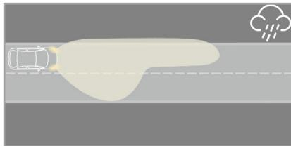
ヘッドライトモジュールの配光を強めて横方向の照射範囲を広げ、走行車線の車線マーカーの視認性を高めます。また、ハイビームの照射範囲を制御して濡れた路面からの反射光を抑えて照射します。照射距離は約220mです。
