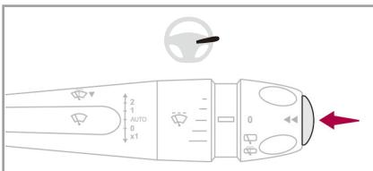
ドライブコンピューターは、ワイパーレバー先端のスイッチを押すことにより、瞬間燃費、トリップ1、トリップ2を切り替えて表示します。
