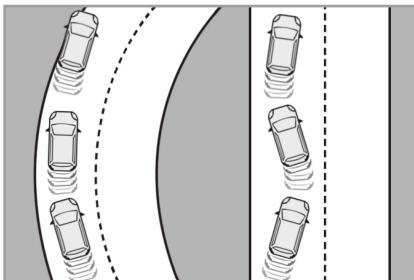
疲労検知システムは、フロントウィンドウ上部のカメラで走行車線の車線マークを検知し、車両のふらつきから運転者の疲労増加や注意力の低下を判断し、警告音とともにメッセージを表示して運転者に休憩をとるように促します。
