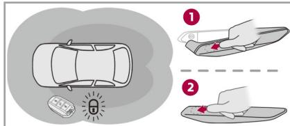
車両周辺の検知エリアにスマートキーがあるときに、いずれかのドアのドアハンドルを軽く押して、すべてのドアおよびテールゲートを施錠します①。3秒以内に再度ドアハンドルを軽く押します②。
