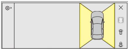
左右のドアミラー下部に取り付けられたカメラの映像を表示し、車両側方の安全確認の補助をします。
